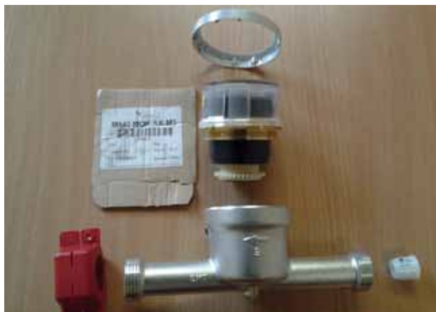
Hier ein Foto vom „Trockenläufer“. Rechts die Verplombung zur Hauptzufuhr (rot), in der Mitte das austauschbare Zählwerk und links der „Rückflussverhinderer“. Gut zu erkennen ist auch das Hauptgehäuse (silbern), das nicht mehr ausgetauscht werden muss.
